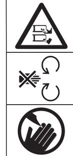
Risk för personskador på grund av roterande knivar eller delar. Stick inte in händer och fötter i maskinens öppningar när den är igång.
