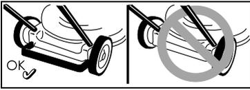
Risque de blessures – Ne travaillez avec qu'avec l'étrier arrière monté.
