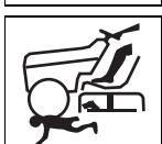
Avant de travailler sur les outils de coupe, débranchez la cosse de la bougie ! Eloignez les mains et les pieds des outils de coupe ! Avant de régler ou nettoyer l'appareil, ou avant de le vérifier, arrêtez son moteur et débranchez la cosse de la bougie.
