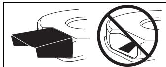
L'appareil ne pourra être exploité qu'avec le clapet d'éjection monté ou la pièce obturatrice pour le paillage.
