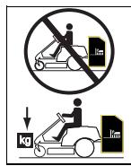
N'exploitez l'appareil équipé du système optionnel de ramassage d'herbe qu'après avoir monté le contrepoids d'équilibrage à l'avant.
